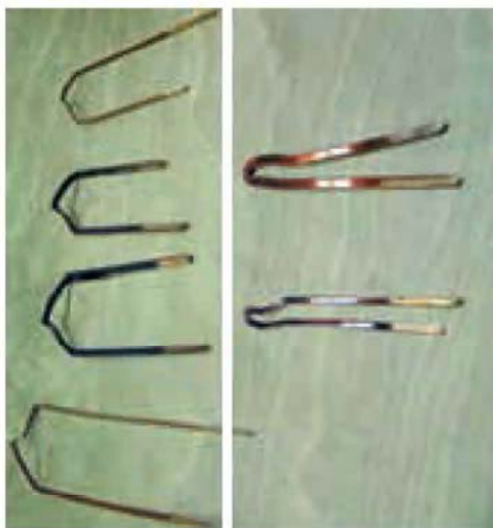
Différentes épingles produites par la machine polyvalente d'APX
